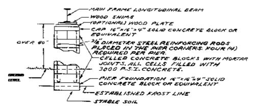
FIGURE 3 - <u>PIERS OVER 80" IN HEIGHT</u> (DOUBLE BLOCK CONSTRUCTION, STEEL REINFORCED)
